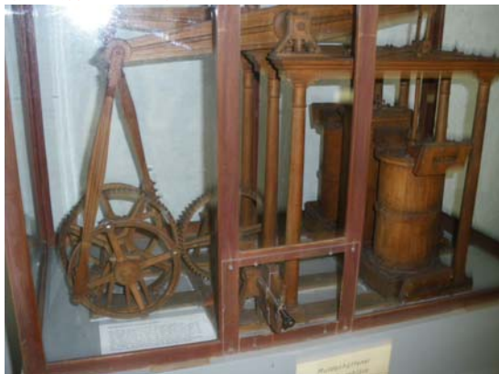
Mulde冶金所で使用されたシリンダー送風機:1828年機械技師Chr.Fr.Brendelによって提案設置され、1954年まで稼働された
